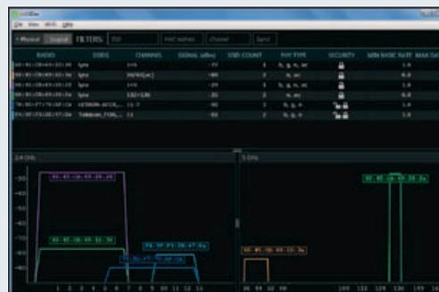
Das Wifi-Tool nSider 4 von Metageeks zeigt hier die Kanalverteilung des Triband-Mesh-Systems Lyra.
